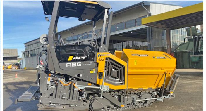
LE FINISSEUR COMPACT AMMANN ABG 2820 OFFRE UNE LARGEUR DE POSE ALLANT DE 1.80 À 3.50 MÈTRES.
