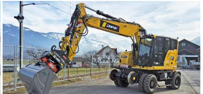
LA PELLE HYDRAULIQUE FERROVIAIRE SUR PNEUS CAT M323F COMPORTE UNE TRANSMISSION HYDROSTATIQUE SUR LES BOGIES UTILISÉS POUR LE RAIL.
