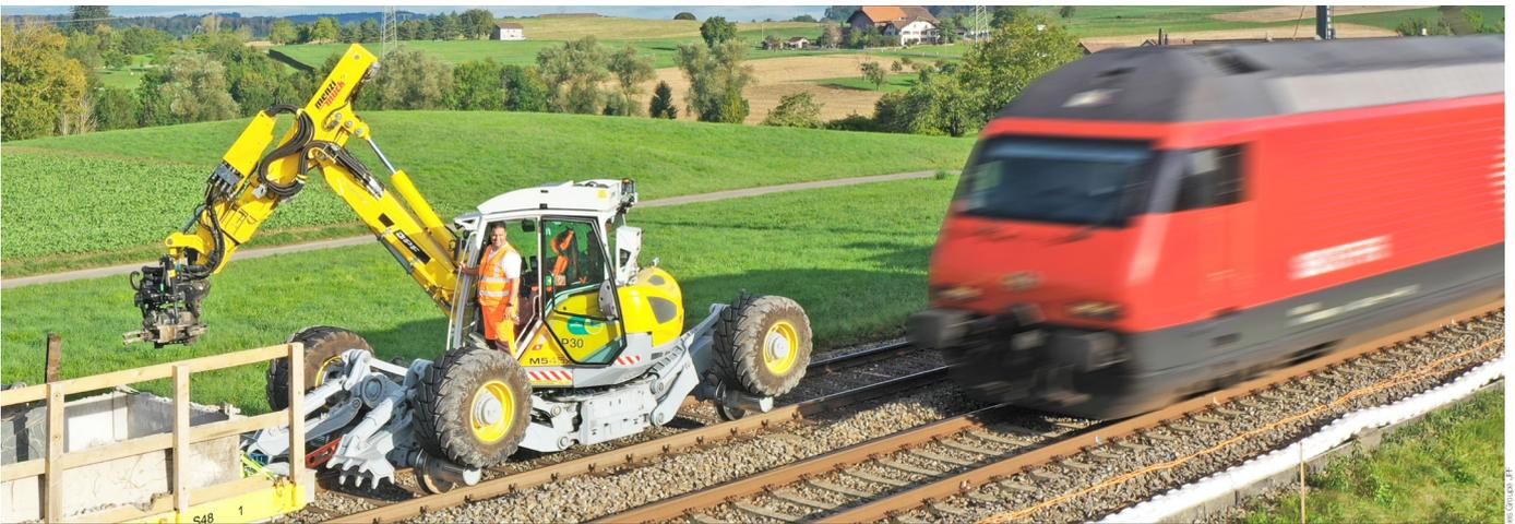
JOSE GUEDES A LA POSSIBILITÉ DE TRAVAILLER EN TOUTE SÉCURITÉ AUX COMMANDES DE SA PELLE MENZI MUCK M545X RAIL-ROUTE. EN OUTRE, GRÂCE AU SYSTÈME D'ENRAILLEMENT ET DE DÉSENRAILLEMENT, LA TRANSFORMATION DE LA PELLE FERROVIAIRE EN PELLE ARAIGNÉE S'EFFECTUE EN QUELQUES MINUTES.
