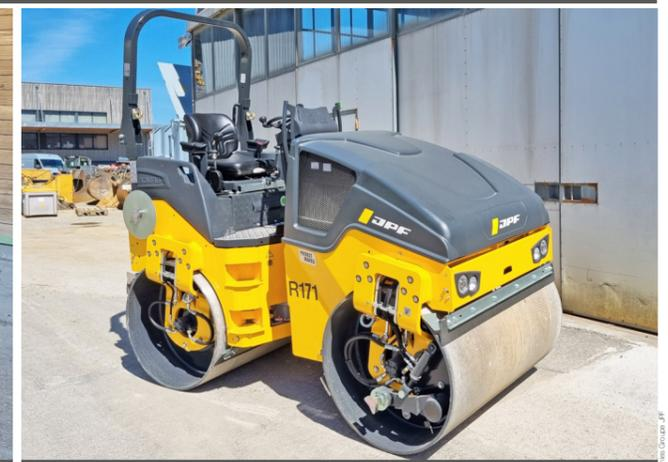
LE ROULEAU TANDEM VIBRANT ARTICULÉ BOMAG BW 138 AD-5 EST PARFAITEMENT À L'AISE DANS LE DOMAINE DES FINITIONS LORS DE CONSTRUCTIONS ROUTIÈRES.
