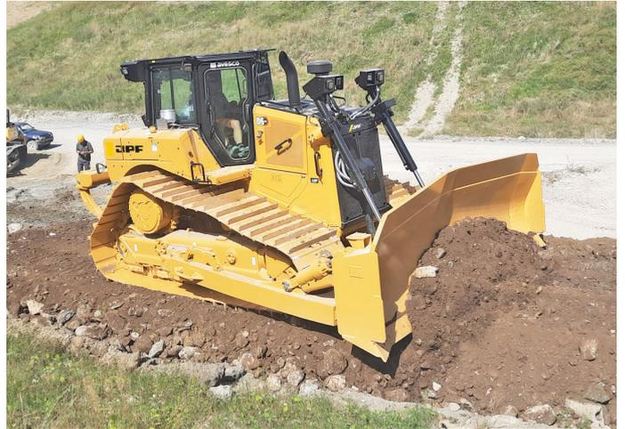
LE BULLDOZER CATERPILLAR D6 XE EST LE PREMIER TRACTEUR À ENTRAÎNEMENT ÉLECTRIQUE AVEC TRANSMISSION SURÉLEVÉE AU MONDE.
