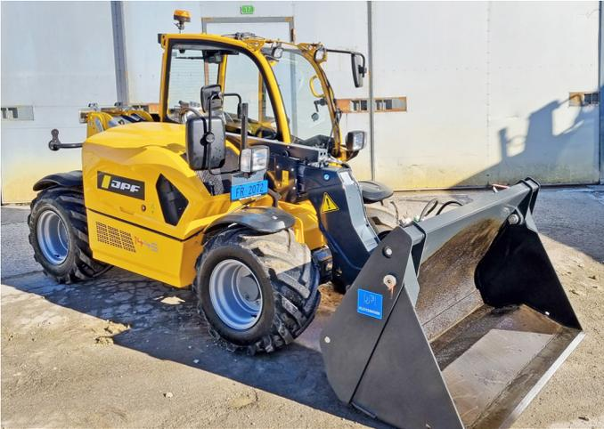
LE CHARIOT TÉLÉSCOPIQUE KRAMER 1445 ATTEINT UNE HAUTEUR DE LEVAGE DE 4,5 M. LA CAPACITÉ DE SON GODET SUR MESURE FLÖTZINGER EST DE 1,3 M<sup>3</sup>.
