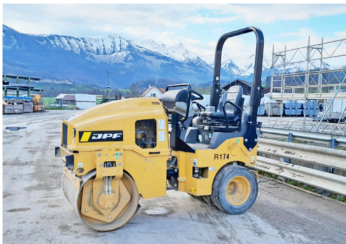
LE COMPACTEUR TANDEM VIBRANT GC CC2.7 DE 2,7 TONNES MÉTRIQUES ET DÉVELOPPÉ PAR CAT A LA RÉPUTATION D'ÊTRE SIMPLE, POLYVALENT ET EFFICACE.
