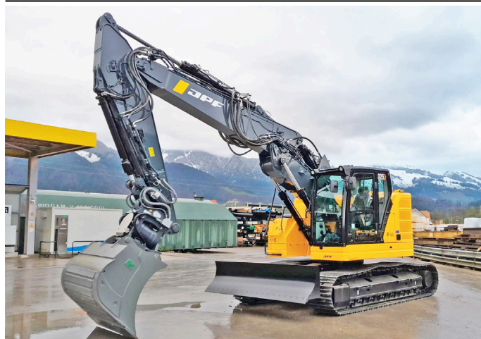
LA PELLE CAT 325: JUSQU'À 25% D'ÉCONOMIE DE CARBURANT GRÂCE À SA POMPE ÉLECTROHYDRAULIQUE ET SA SOUPAPE DE COMMANDE PRINCIPALE.
