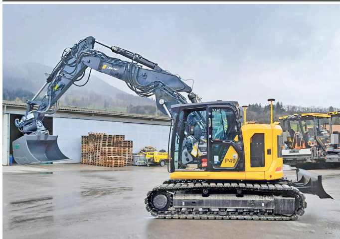
PETITE MAIS NÉANMOINS CAPABLE D'UNE PROFONDEUR D'EXCAVATION DE 6 M, LA PELLE HYDRAULIQUE CAT 315 EST POUR LE MOINS BLUFFANTE.
