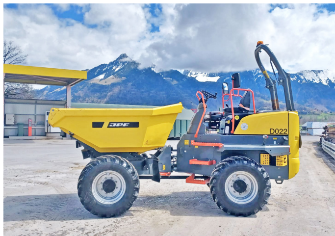
TOUTES LES FONCTIONS IMPORTANTES DU DUMPER WACKER NEUSON DW60-2 SE TROUVENT À PORTÉE D'UNE SEULE MAIN, COMMANDÉES PAR JOYSTICK.
