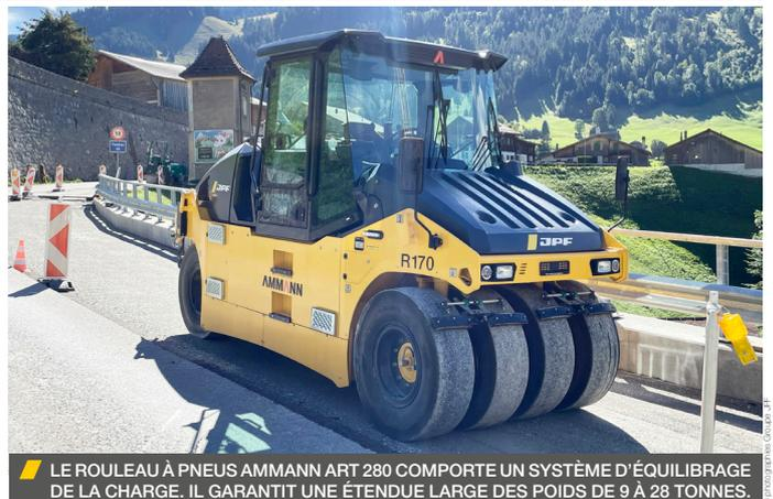
LE ROULEAU À PNEUS AMMANN ART 280 COMPORTE UN SYSTÈME D'ÉQUILIBRAGE DE LA CHARGE. IL GARANTIT UNE ÉTENDUE LARGE DES POIDS DE 9 À 28 TONNES.
