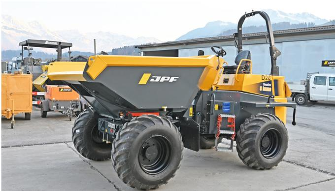
/// BARDÉ DE SÉCURITÉ, LE DUMPER THWAITES D'UNE CHARGE UTILE DE 9 TONNES EMBARQUE UNE CAMÉRA FRONTALE POUR UNE VISION OPTIMISÉE VERS L'AVANT.
