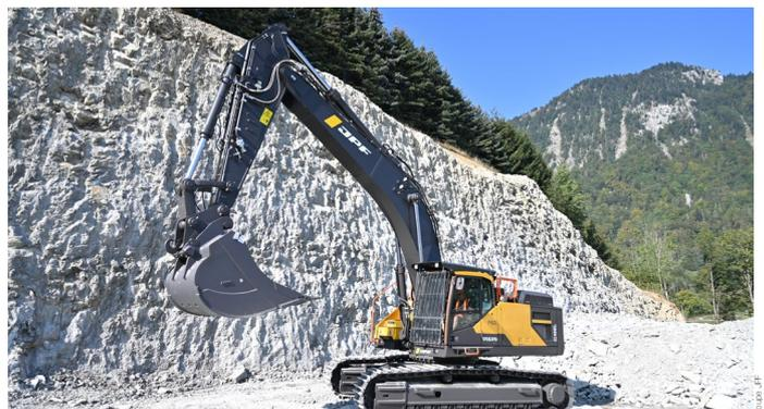
LE MODE ECO ET UN SYSTÈME DE COMMANDE ÉLECTROHYDRAULIQUE DONNENT À LA PELLE VOLVO EC480E DE 50 TON UN RENDEMENT ÉNERGÉTIQUE AMÉLIORÉ.
