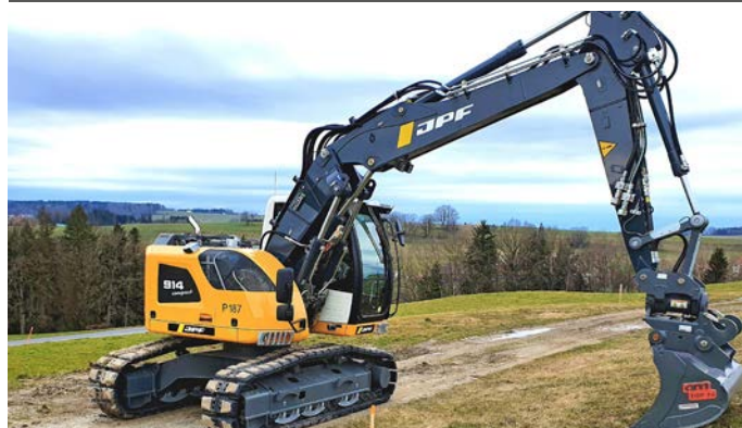
L'HYDRAULIQUE ET L'ÉLECTRONIQUE DE LA PELLE LIEBHERR R 914 COMPACT OFFRENT TROIS MODES DE TRAVAIL: PRÉCISION, ÉCONOMIE OU PERFORMANCE.
