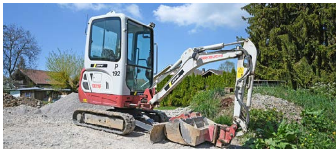
LA PELLE MÉCANIQUE COMPACTE TAKEUCHI TB 216A EST MUNIE D'UNE CABINE PROTECTRICE EN CAS DE RETOURNEMENT, BASCULEMENT OU CHUTE D'OBJETS.
