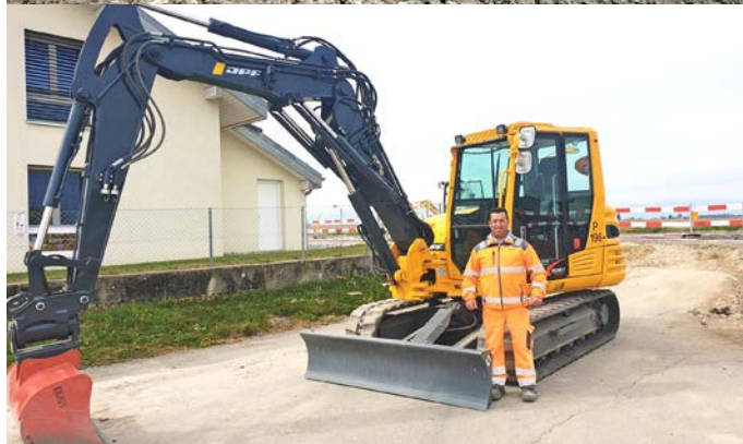
FRÉDÉRIC ROMANENS ET RUI MANUEL DA SILVA (EN BAS) SONT AUX COMMANDES DU MÊME TYPE DE PELLE: TAKEUCHI TB 290-2 V À FLÈCHE VARIO. ELLES COMPORTENT UN LIMITEUR DE COURSE RÉGLABLE (ROTATION ET HAUTEUR) DÉDIÉ À LA SÉCURITÉ. LEUR SYSTÈME HYDRAULIQUE UTILISE DES HUILES BIO.
