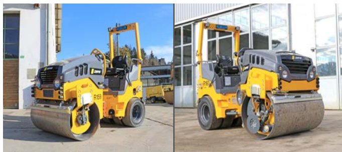
DEUX ROULEAUX HAMM TANDEM MIXTES HD 12i VT COMPACT LINE (À GAUCHE) COMPLÈTENT L'INVENTAIRE GC. LE MODÈLE 14i VT EST DESTINÉ AUX REVÊTEMENTS.
