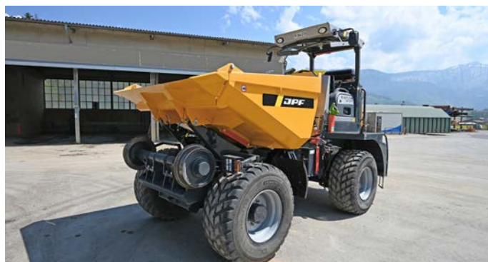
LE DUMPER BERGMANN 2090 R PLUS RAIL / ROUTE COMPORTE DEUX ESSIEUX FERROVIAIRES VARIABLES EN LARGEUR (VOIE MÉTRIQUE OU VOIE NORMALE).
