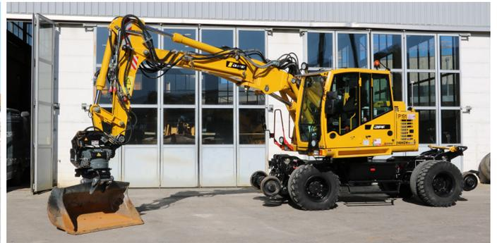
LA PELLE PNEUS RAIL/ROUTE ATLAS 1404 ZW DE 21.5 TO, PILOTÉE PAR LUIS OLIVEIRA, COMPORTE UNE FLÈCHE À VOLÉE VARIABLE AVEC DÉPORT LATÉRAL.
