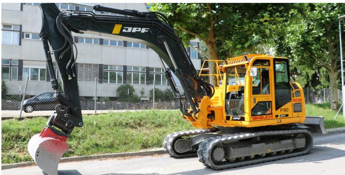
AUX COMMANDES D'ABILIO VARELA, LA PELLE SUR CHENILLES CAOUTCHOUC TAKEUCHI TB 2150 POSSÈDE UN BRAS DÉPORTABLE DROITE ET GAUCHE.
